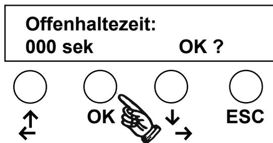
Die Offenhaltezeit kann zwischen 0 und 299 Sekunden (0-5 Minuten) eingestellt werden. Die erste Ziffer der Sekundeneinstellung blinkt auf der "hunderter Stelle", hier kann nun mit den Pfeiltasten  $\uparrow$   $\downarrow$  eine Ziffer zwischen 0 und 2 eingestellt werden. Soll die Ziffer übernommen werden, so ist sie mit der OK-Taste zu bestätigen.
