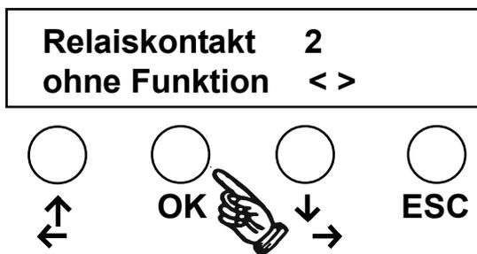
Nach der Anwahl über die OK-Taste, erscheint die Anzeige, wie hier dargestellt. "**Relaiskontakt 2 ohne Funktion**". Mit den Pfeiltasten **↑↓** kann die gewünschte Funktion vorgewählt und über die OK-Taste eingestellt werden.
